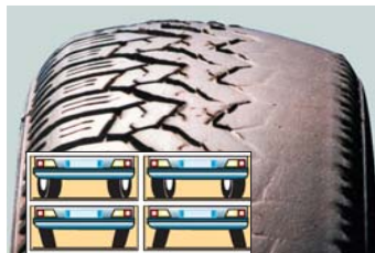
Les conséquences d'un mauvais réglage de la géométrie des trains roulants.
